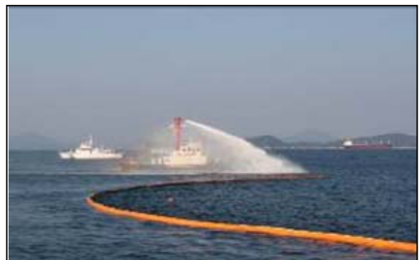
オイルフェンスの展張および 流出油の拡散・回収
