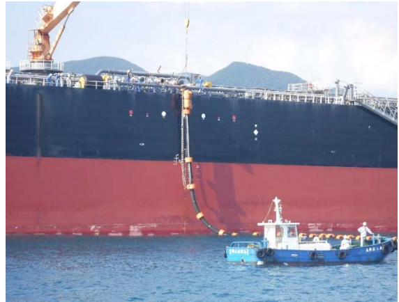
浮沈ホース取付中
