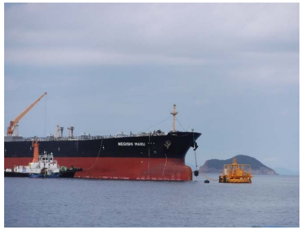
タンカー側へ係留索取付中
