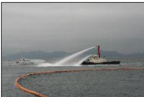
オイルフェンスの展張及び浮遊油の拡散
