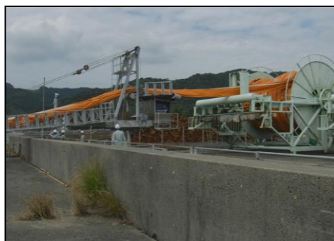
オイルフェンス展張訓練
