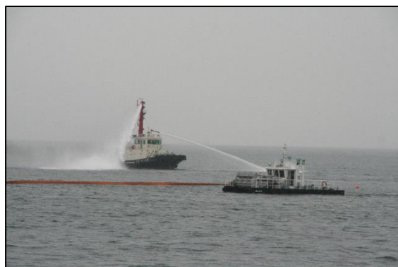
オイルフェンスの展張および 流出油の拡散・回収
